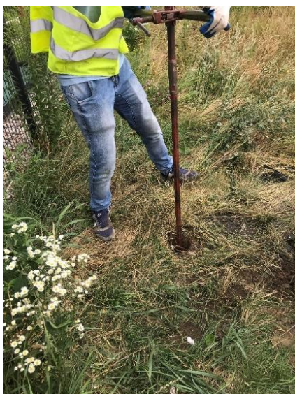
Rys. 5. Widok ogólny wykonania odwiertu w gruncie z wykorzystaniem wiertnicy ręcznej.
