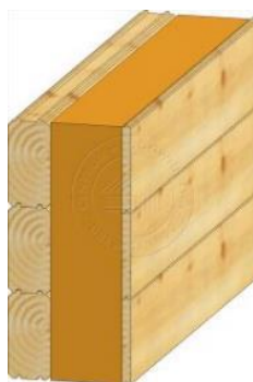
Rys. 3. Ściana z bali izolowanych, [2].
